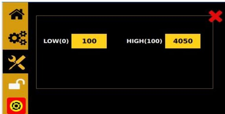
Abbildung 7: Bildschirm „Luftdruckkalibrierung“
