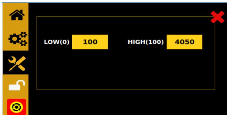
1. 将后部进气口的气压降至零 (0) PSI。轻触“LOW (0)”压力测量框。注意：黄色框内是内部无单位压力测量。测量框将会更新。
