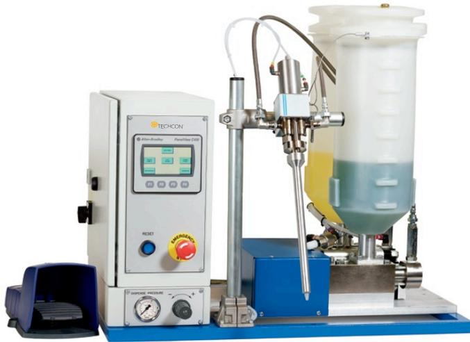
Les TSM50FR et TSM120FR sont des machines de dosage, de mélange et de mesure à rapport fixe. Ils sont alimentés pneumatiquement et contrôlés numériquement à l'aide d'une technologie PLC avec écran tactile HMI permettant l'interface facile d'une large gamme d'accessoires électriques et robotiques.
